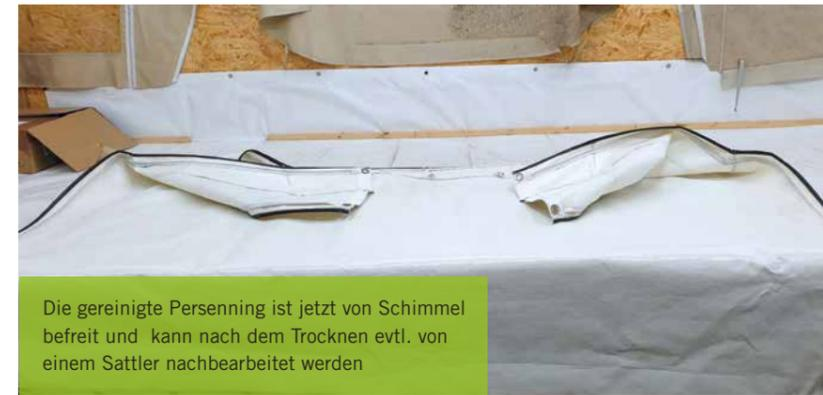
Die gereinigte Persenning ist jetzt von Schimmel befreit und kann nach dem Trocknen evtl. von einem Sattler nachbearbeitet werden
